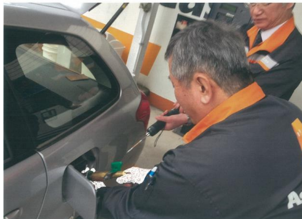
オートガス充填作業時のブタン濃度測定
