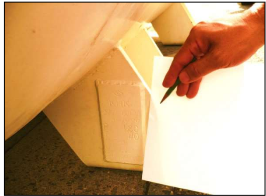
バルク貯槽刻印の拓本取り (例)
