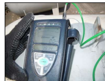
ガス濃度測定(例)
