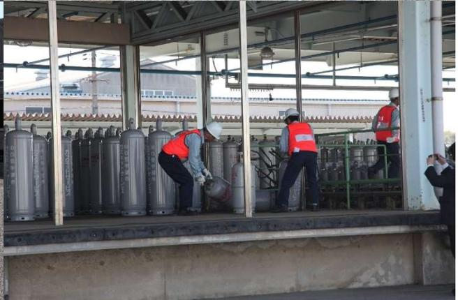
○進入禁止措置～緊急点検～No.1 貯槽フランジ部漏洩確認～応急処置～散水実施
