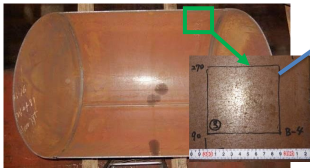
【開放後、1か月間、空気にふれた状態】 全面に赤錆を視認。 錆の程度が大きいと想定される箇所を選定し断面観察。 注) 写真は切断したバルク貯槽。
